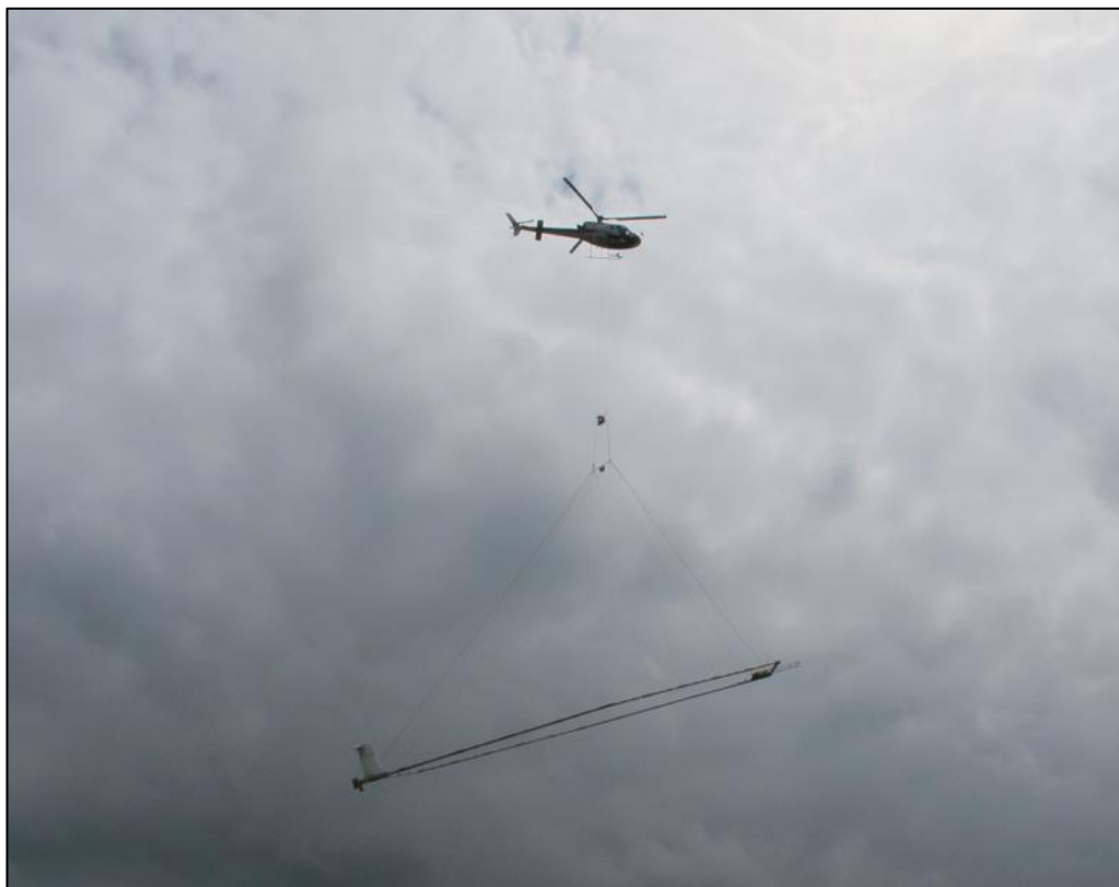
Figure 3 SkyTEM 312M Airborne unit.
