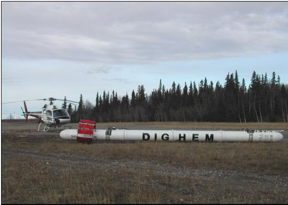
Figure 1-1: Fugro Airborne Surveys DIGHEM EM Bird
